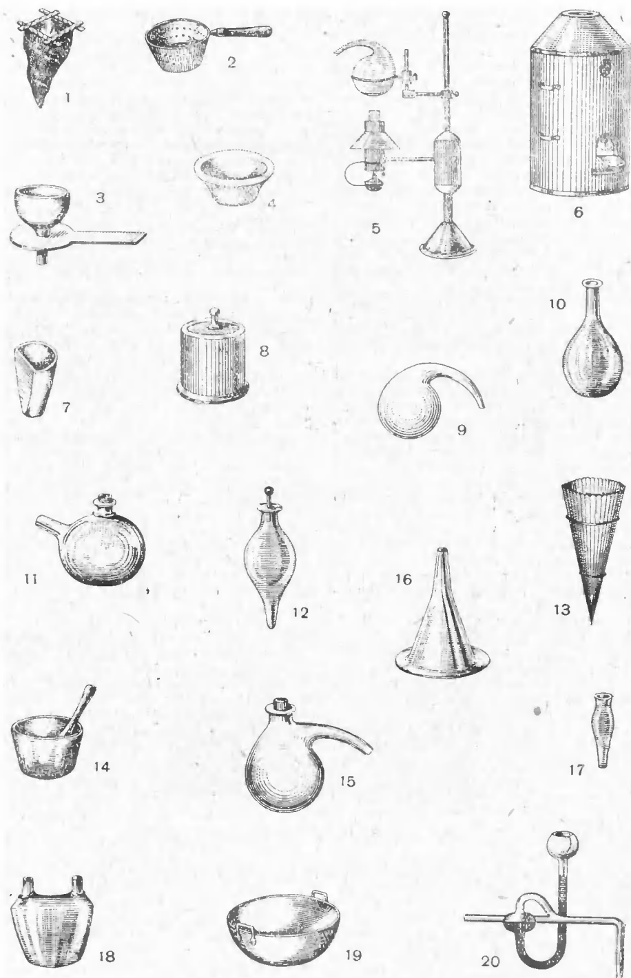
Лабораторное оборудование и посуда по А. А. Иовскому: 1 — гипократов чулок для процеживания; 2 — скважистая педилка; 3 — лейка в подставке; 4 — чашка для выпаривания; 5 — ламповая печь; 6 — ручная песочная печь; 7 — тигель бызает треугольный или круглый; 8 — тигель с крышкой; 9 — реторта; 10 — приёмник; 11 — трубчатый приёмник; 12 — лейка для отделения эфирных масел кои тяжелее воды; 13 — тростниковая или из прутьев сделанная воронка для процеживания, внутрь её вкладывается педилка; 14 — ступка; 15 — реторта с горлушком в шейке; 16 — колба с плоским дном; 17 — подставная трубка с выпуклыми боками; 18 — двугорловая склянка; 19 — эндова из красной или жёлтой меди; 20 — стеклянные трубки для предохранения от гибельных действий при очищении кислот.
